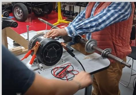
Rendimiento motor ME0909, primera prueba de 24V usando baterías de plomo ácido
